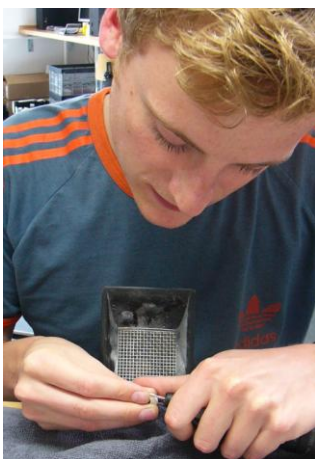
Abbildung 3: Ausarbeiten der Keramikkrone
