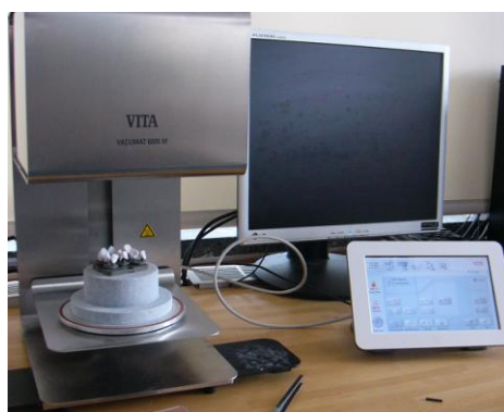
Abbildung 4: Keramikofen der Firma VITA Zahnfabrik
